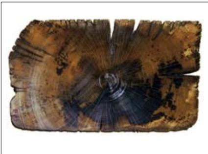
Im Querschnitt einer alten Quelle wird die verbliebene Teerimprägnation sichtbar.
